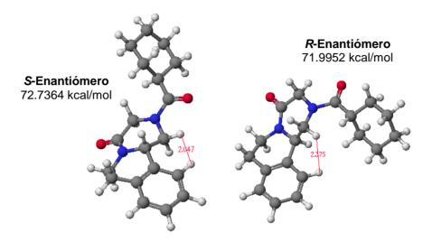
Figura 1.15 Análisis estructural de los enantiómeros S-PZQ y R-PZQ.
