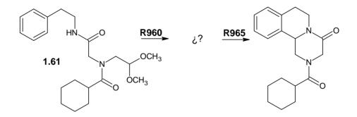
Figura 1.14 Secuencia de reacciones en la obtención del PZQ.
