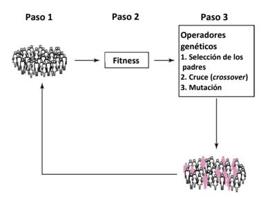
**Figura 1.8** Esquema general de un algoritmo genético. En el primer paso, se tiene una población inicial de individuos. Luego, la "aptitud" (en inglés, *fitness*) de cada individuo es evaluada (paso 2). La selección de los individuos basada en su "aptitud", en la aplicación de operadores genéticos, en el cruce (en inglés, *crossover*) y la mutación genera la primera descendencia (paso 3). Los pasos del 1 al 3 son repetidos de forma iterativa (98).
